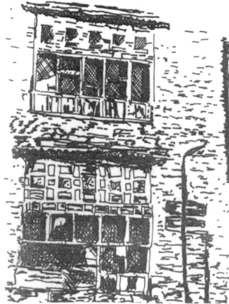
رسم يمثل روشان مبسط من (الفئة الأولى) تتكون فيه المشربية من ثلاث إلى خمس وحدات، فيما يظهر روشان الدور الأرضي وقد غطيت المشربية بقوائم من الحديد المثبت بجوار بعضه البعض وعلى أبعاد تتراوح من ٥ إلى ٨ سم
