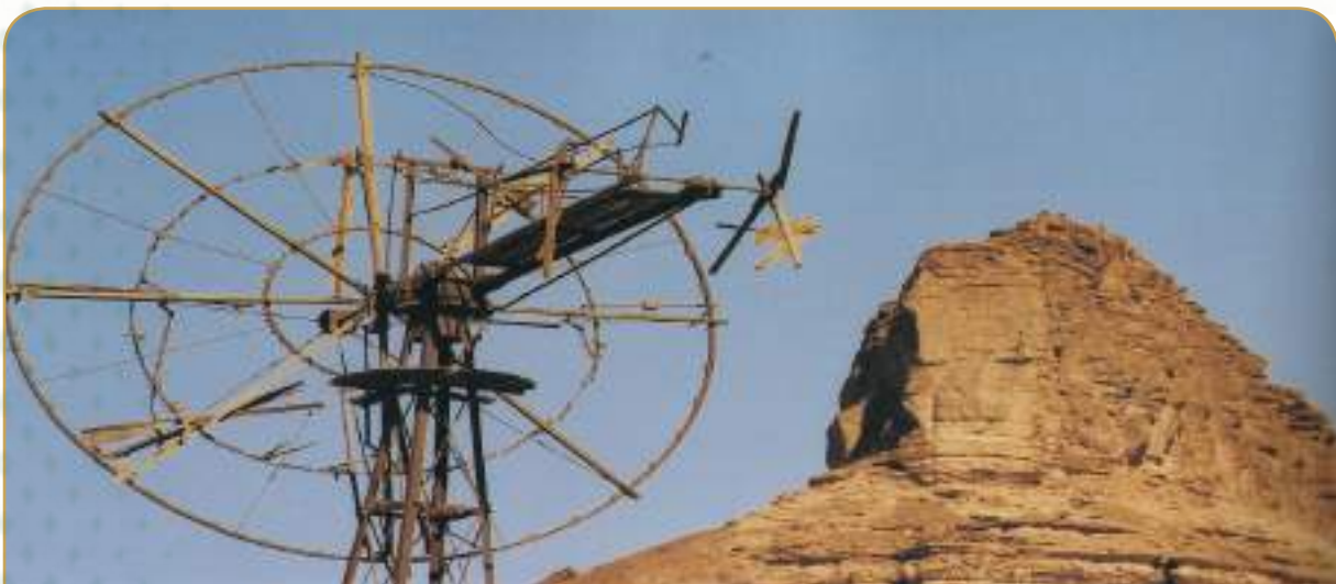
مروحة هوائية قديمة لرفع الماء بمحطة قطار الحجاز بالعلا
